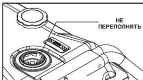
Рисунок 6. Максимальный уровень заполнения топливного бака.
