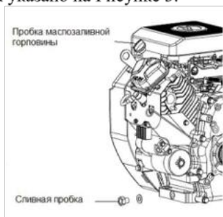
Рисунок 3. Проверка уровня моторного масла.
