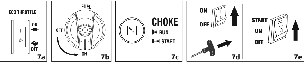
Рисунок 7 – Ручной и электрический запуск
